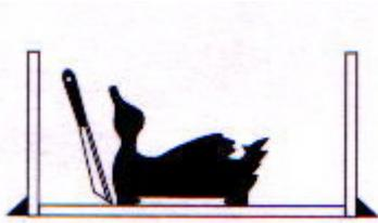
3. Coloque una tira de masa de plastilina en la base del original. Presione el original firmemente sobre la superficie de la caja de moldeo. Retire todo exceso de masa. Marque la posición del original en la base de la caja.
