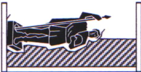
4. Cubra la parte expuesta del original con una camada de 3mm de plastilina. Coloque pins de alineamiento en la arcilla.
