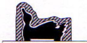
5. Arme la caja de moldeo alrededor del original. Vierta un material de soporte como yeso, poliuretano, resina, etc. Dentro de la caja, hasta llenarla totalmente.
